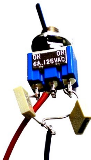
Bild 3. Ett sätt att justera tonkaraktären hos det repeterade ljudet är att växla mellan två olika kondensatorvärden på positionen C12.
