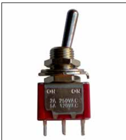
Bild 2. En till/till switch har tre stift. Mittenstiftet är "till" med ett av de övriga. Den kan användas för att ställa en gitarrsignals väg genom en krets.
