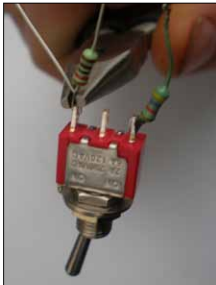
Bild 5. Originallet och den nya fästs på switchen.
