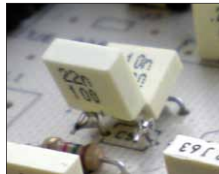
Bild 7. Parallellkopplar två kondingar på en Cry Baby för att flytta ner "wah-omfånget".
