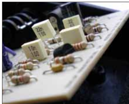
Bild 6. Om man ersätter originalet med en 22 nF får pedalen ett annat djup.
