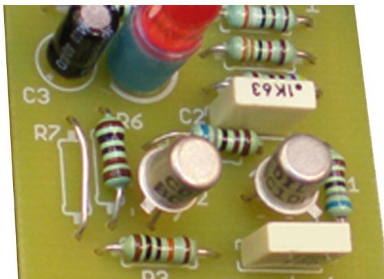
Bild 3. En Moody Fuzz där BC108C används och där R7 = 0 Ohm.
