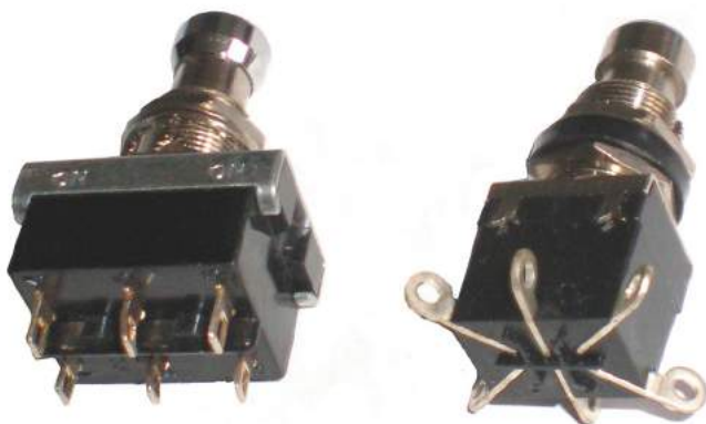
Bild 11. En tvåpolig till-till switch är som två enpoliga till-till switchar men där omkastningen görs med en knapp eller en arm. Bilden visar två olika fabrikat av 2PDT tryckströmställare (fotomkopplare).
