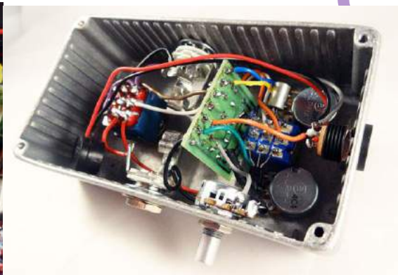
Bild 9.3 och bild 9.4. Sladdar ansluts mellan kort och omkopplare. Hål borras i lådan och transistorväxlaren är ett faktum.
