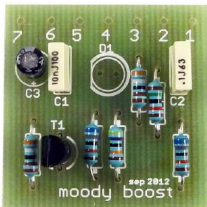
Bild 2. Moody Boost kretskort och komponenter. R4 är placerad precis till vänster om C2. Sänk R4 för mindre gain, öka R4 för mer gain.
