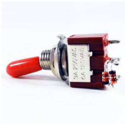
Bild 5.1 och bild 5.2. En vippkopplare som växlar mellan boost-läge (dioder inaktiva) och dist-läge (dioder aktiva).
